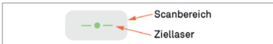
4. Achten Sie darauf, dass sich der Barcode innerhalb des beleuchteten Scanfelds befindet, wie unten dargestellt:
