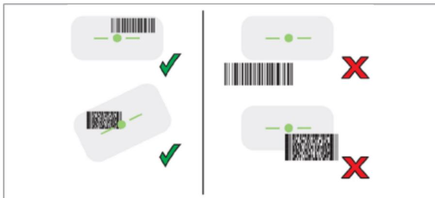
5. Nach erfolgreicher Erfassung des Barcodes stehen mehrere Feedback-Optionen zur Verfügung. Standardmäßig ist ein kurzer Signalton aktiviert, aber in der Scan Engine control App ist unter den jeweiligen Profileinstellungen auch ein haptisches Feedback (Vibration) verfügbar.
